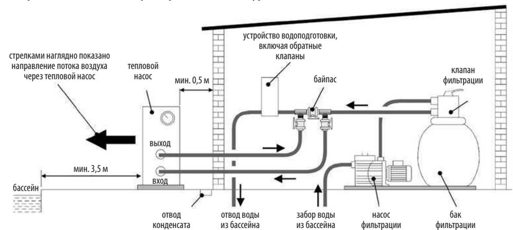
**Примечание:** Изготовитель поставляет только тепловой насос. Остальные компоненты, изображенные на рисунке, являются составными частями водяного контура, которые обеспечивает пользователь или монтажная фирма.
